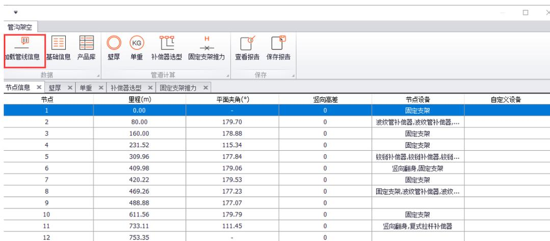
图2.35 管沟管线信息导入界面
