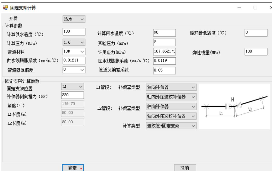
图2.40 固定支架推力计算对话框
